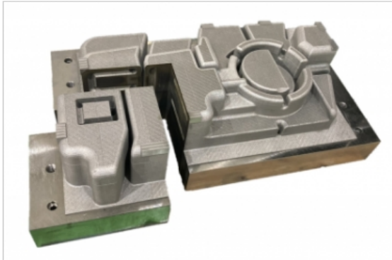
ソディックの金属AM機による大型造形サンプル
